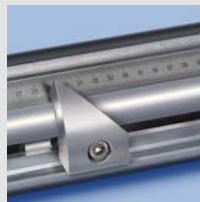
Setzwerkzeug einstellbar auf die Wanddicke
